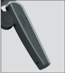
Entfernen Sie die Zugangsabdeckung zum USB-Anschluss mit dem entsprechenden Werkzeug.
