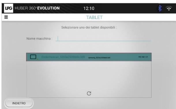
L'apparecchiatura rileva automaticamente il tablet. L'icona «tablet» che appare in alto a destra dello schermo della vostra apparecchiatura e di quella del tablet vi garantiscono che la connessione sia operativa.
